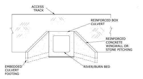
TYPICAL BOX CULVERT ELEVATION (NTS)
