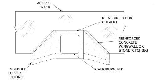
TYPICAL BOX CULVERT ELEVATION (NTS)
